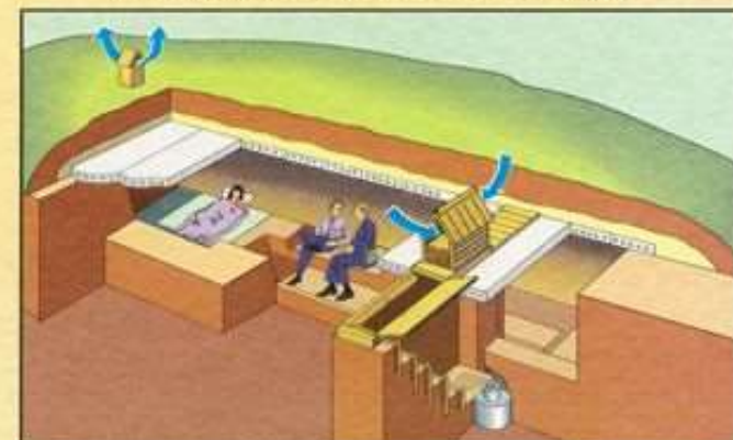
Быстровозводимое противорадиационное укрытие из железобетонных плит
